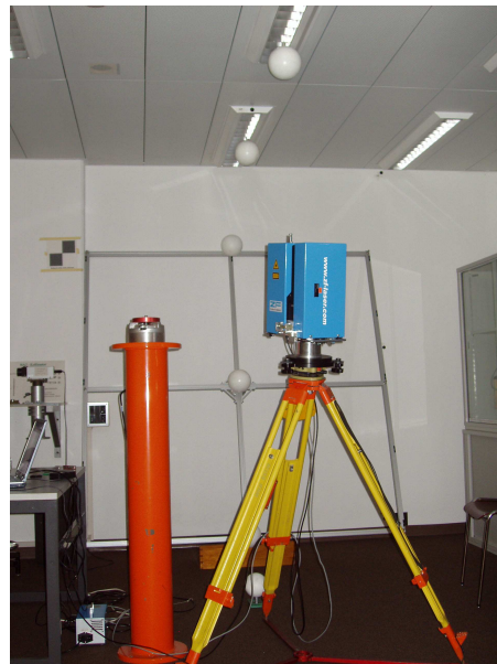
Abb. 8: Messaufbau zur Bestimmung von Ziel- und Kippachsenfehler eines Laserscanners
